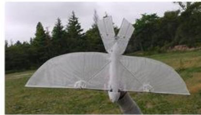
3D プリンターで製作した部品は、カーボンロッドとつり用の PE ライン、中粘土耐衝撃性瞬間接着剤で補強した。重量はほぼ同じで、強度もカーボン製の羽ばたき機とほぼ同等のものができあがった。飛
