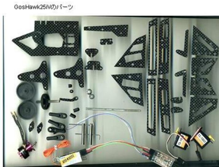
図7 Goshawk25iV with articulated wing (オオタカ: 関節がある翼) の部品。カーボン部品は素材
